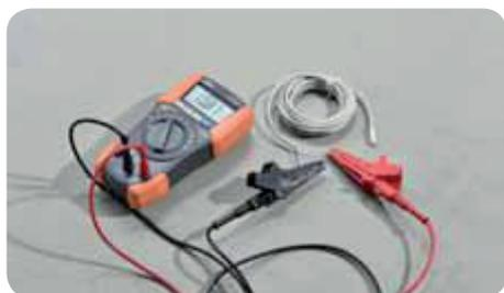
**4** Verifica del sensore di temperatura a pavimento.
