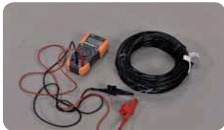
**1** Misura della resistenza del cavo scaldante.
