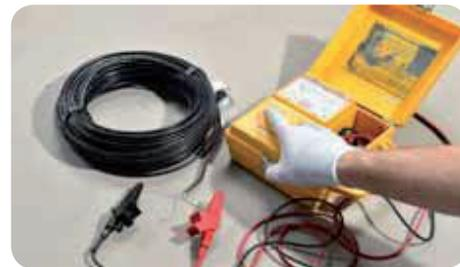
**3** Misura della resistenza dell'isolante tra cavi conduttori e cavo di messa a terra.
