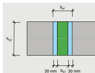
la prova a schiacciamento è condotta mediante un valore di  $k_{c,90}$ -Wert di 1,25 come per il legno massiccio. Inoltre, il fattore correttivo per la classe di servizio 1 è pari a 1,20 (secondo certificazione tedesca AbZ Z-9.1-842).
