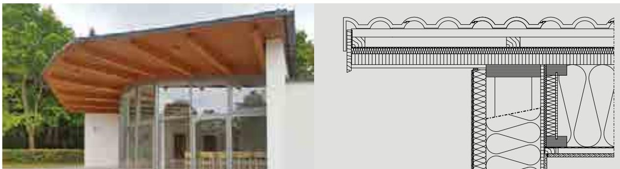
Costruzione di tettoie snelle con ottica pregiata possono essere realizzati facilmente ed economicamente mediante STEICO LVL X. Si consiglia - già in fase di pianificazione - di tenere in considerazione la posizione dei pannelli e l'orientamento della fibratura degli stessi. In corrispondenza degli angoli si verificano le deformazioni maggiori, per questo motivo vengono di seguito presentate soluzioni elaborate per questo caso.
