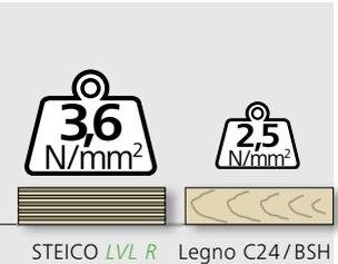
Estrema capacità portante in ogni sezione, ad esempio nel caso di correnti di base e travi marcapiano. In tal modo non solo vengono ridotti sia il peso che in materiale, ma diminuisce anche il cedimento.
