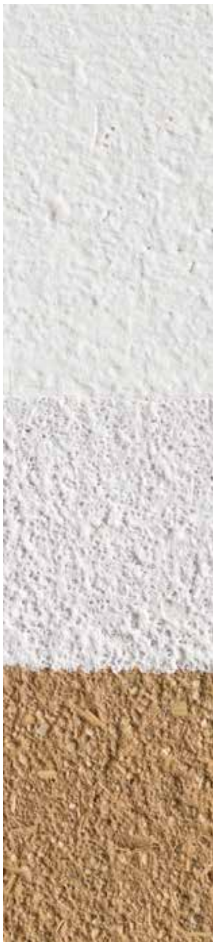
Intonaco di finitura d'argilla: 2 mani di colore argilla Edelweiß
